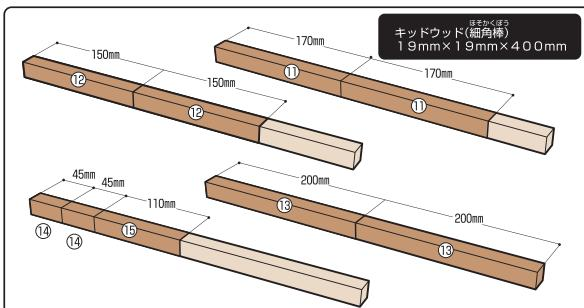
4 キッドウッド丸棒を大型ノコギリや超小型ノコギリでカットします。
