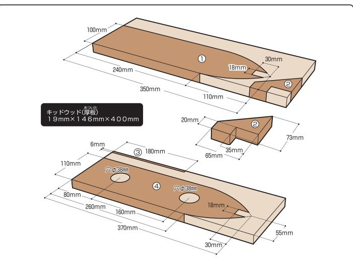
5 カットした部材をクギで打ち付けます。
