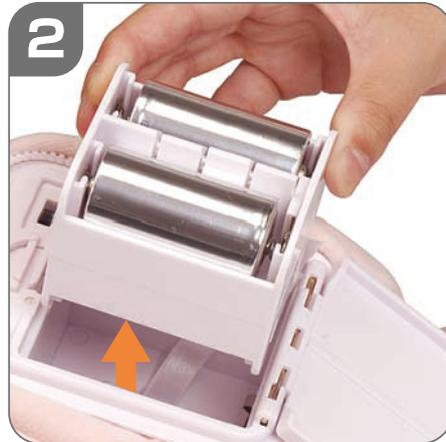
中から③電池ケースを取り出します。ボックス内部の底面にコイン形電池カバーがあります。
