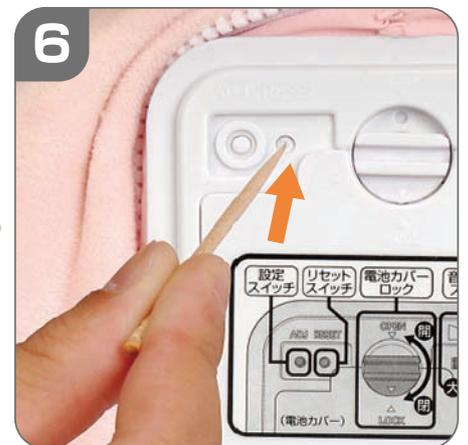
②電池カバー上部にある【リセットスイッチ】を、ペン先など、先の細い棒で押してください。背中中のファスナーを閉めてください。
