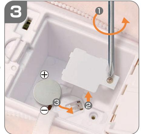
コイン形電池カバーのネジを⊕ドライバーで取り外し、+の向きに注意して新しいコイン形電池をセットしてください。コイン形電池カバーをもとに戻し、ネジをしっかりと閉めてください。
