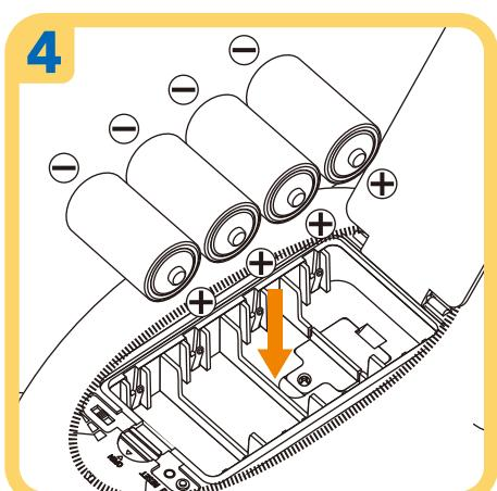
乾電池4本を図のように+の向きに注意してセットし直してください。
