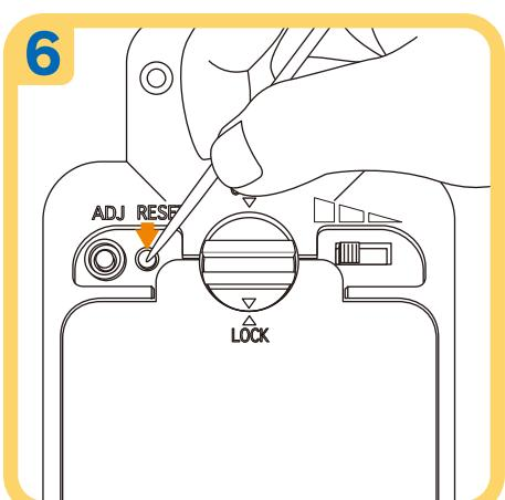
**②電池カバー** 上部にある**リセットスイッチ**を、ペン先など、先の細い棒で押してください。
