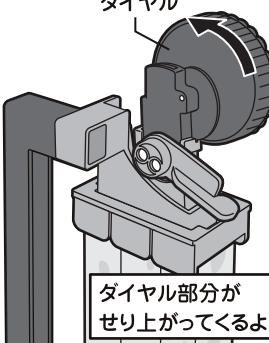
5 せり上がったたら、クリップを上げて、 ダイヤル部分を元の位置に戻します。
