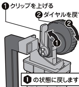
6 3～5を3回繰り返します。 テコの原理でダイヤルを回すたびに少しづつ引き抜いていきます。
